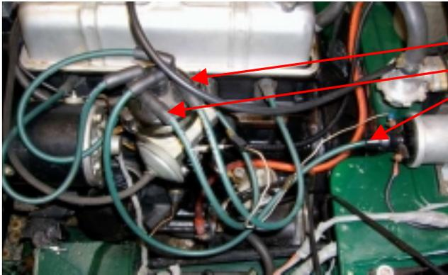
Il ne vous reste plus qu'à remettre la tête de Delco, de brancher les fils de bougies sans oublier les fils de haute tension.
