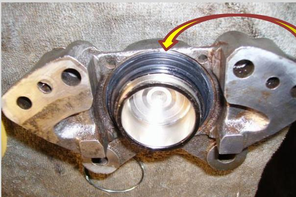
*Pour faire tenir le cerclage avec le joint il faut les limer à l'intérieur pour qu'il soit plus plat et qu'il accroche mieux sur le cache, on peut également le recouper de 5 mm.*
