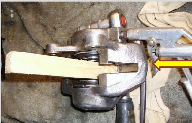
Essai du fonctionnement en intercalant une cale de bois pour ne pas faire ressortir les pistons et avec un petit coup de soufflette on voit de suite si cela fonctionne.
