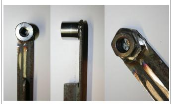
Vérifier la bonne adaptation de la douille sur l'écrou soudé
