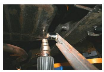
**Bonus :** Utiliser un décapeur thermique pour réchauffer la tôle autour du bouchon et, éventuellement, décoller un Frein-Filet mal placé dans le filetage.
