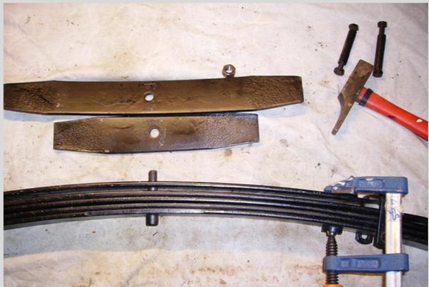
Remettre les vis sur les cavaliers en s'aidant d'un serre joint, ça force un peu au niveau du tube mais si le serre joint est bien serré ça passe.
