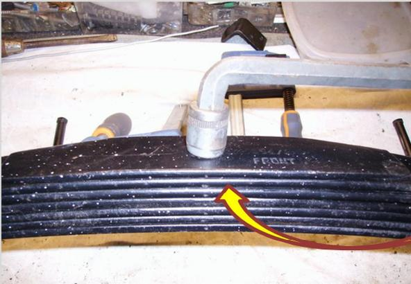
Il faut desserrer la vis qui permet de centrer les lames sur le pont après avoir retiré tous les cavaliers .les lames sont bien sur repéré pour le front avec **un coup de pointeau comme sur la photo.**
