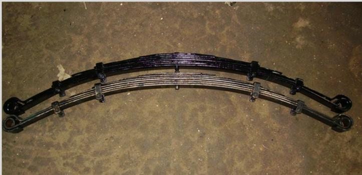
Comparaison des deux lames, la neuve avec pastilles téflon et la vieille avec pastilles caoutchouc. En traçant une ligne droite des axes au milieu on trouve une différence de 1.5 cm
