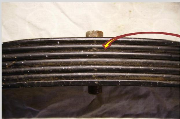
**Pensez à donner des coups de pointeau sur le champ de la lame du côté ou c'est marqué front.** C'est important pour le remontage comme nous allons enlever toutes les lames pour lui mettre des pastilles en téflon à la place des pastilles en caoutchouc.
