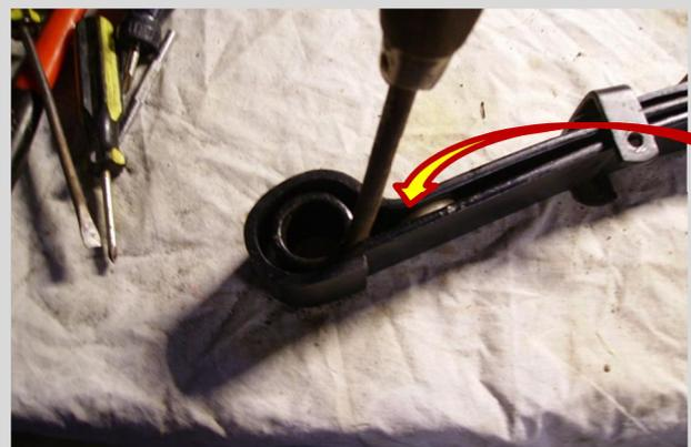
On va changer les deux sillent bloc de chaque côté de la lame. **Pour se faire on va forcer un tournevis** ou on peut taper dessus pour écarter légèrement le diamètre afin de **facilité la sortie du sillent bloc.**
