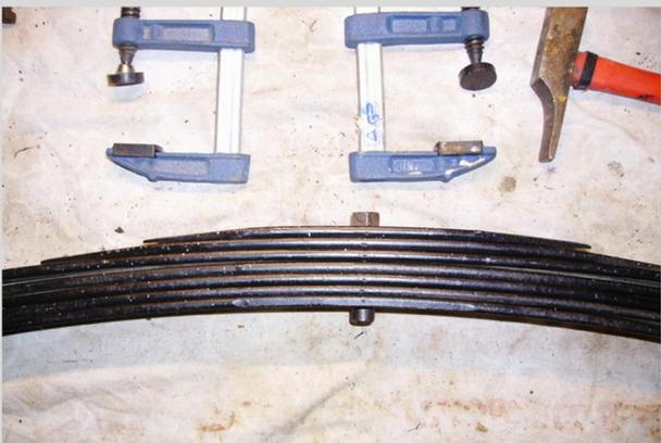
Voilà, les lames sont remontées reste plus qu'à les peindre superficiellement.
