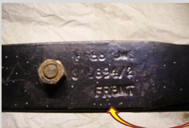
Voici une lame de ressort de mk3 en bonne état que nous allons la renforcer par des pastilles (Pulmoll). D'abord dans un premier temps changer les Sillent bloc en bout de lame par des neuf. il va donc falloir désaccouplée la lame entièrement. Dans ce cas nous allons faire les repérages qui s'imposent. **Vous avez remarqué que sur la lame il est marqué Front**
