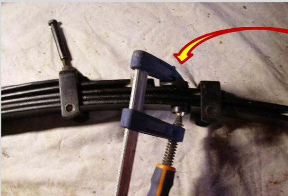
**Pour cela il faut serrer un serre joint** sur les lames afin de les rapprocher et de faciliter le démontage des colliers des lames, les boulons sont tous de la même longueur donc pas besoins de repérage.
