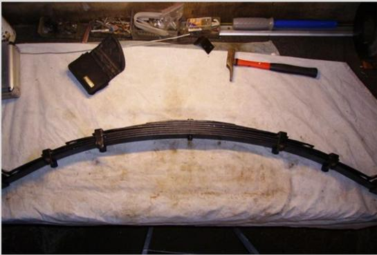
Voilà pour les lames de ressort de spit MK3 avec des pastilles en téflon pour l'écartement des lames.
