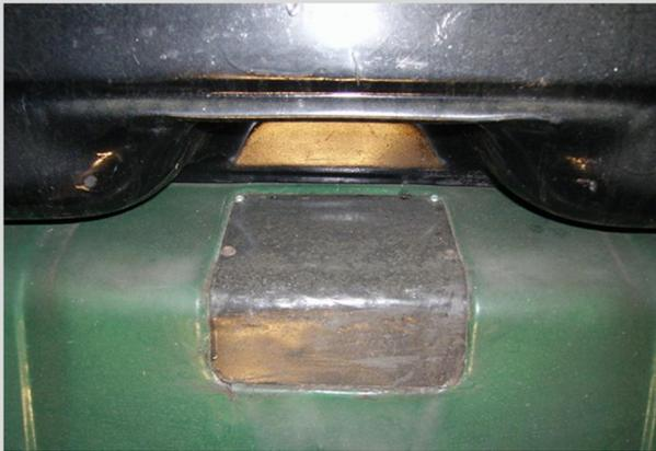
Démontage de **la plaque en tôle** pour avoir accès au support des lames.
