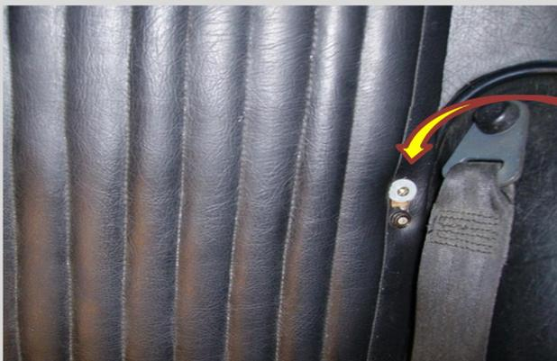
Commencer par retirer le panneau arrière qui doit être fixé **par deux vis** ou quatre cela dépend de celui qui a restauré la voiture au pare avant.
