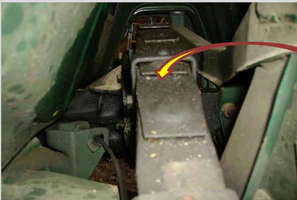
La lame que l'on va retirer pour la changer et mettre des pastilles en téflon pour remonter l'arrière afin qu'elle n'ait plus cette aspect Gordini
