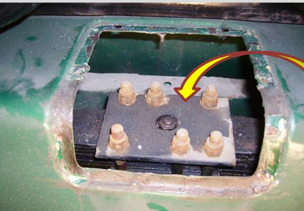
La tôle étant démontée, on voit bien la fixation de la lame sur le pont.
