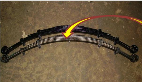
En les comparant l'une à côté de l'autre et en mesurant, je trouve une différence de courbe de **1,5 cm de moins sur la vieille lame.**
