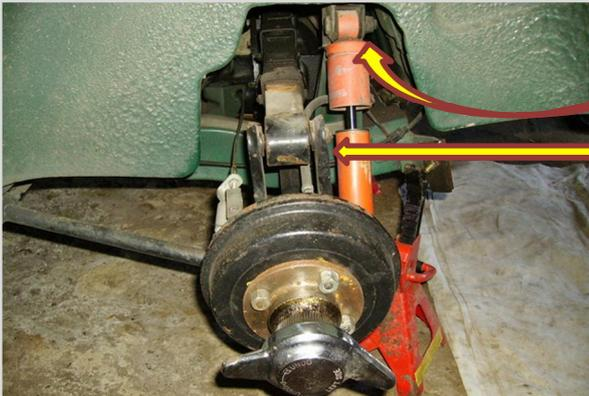
Nous allons démonter la suspension en bas du train et le gros boulon qui traverse entièrement la lame. Le demi-train va donc descendre pour nous laisser de la place pour retirer entièrement la lame
