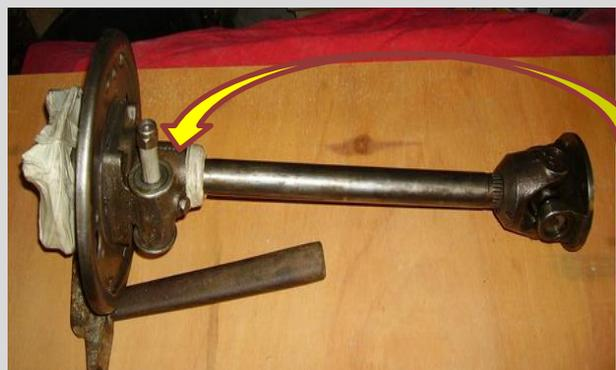
Je les aie donc remontés avec **une vis** pour les tenir et les protéger pour le ponçage et la peinture.
