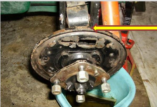
Comme j'avais déjà démonté les roues les tambours et la lame de ressort et la suspension. Il ne reste plus cas démonté les quatre boulons qui se trouve sur le pont et de désaccoupler les tuyaux de freins pour les deux demi-trains
