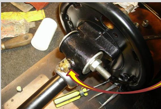
Il ne reste plus qu'à **remettre la vis à la place du graisseur**
