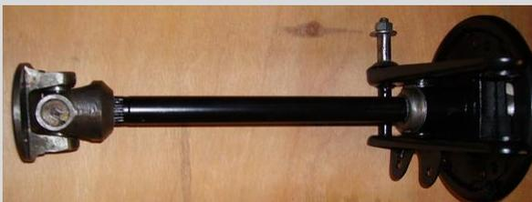
Pour des raisons d'esthétique et en plus cette endroit avec la graisse ne tiens pas dans le temps j'ai donc préféré les vernir avec un vernis haute température
