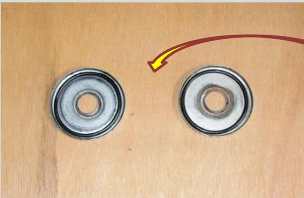
**Les joints et les petites tôle** de protection ne sont pas rouillé n'y abimer.
