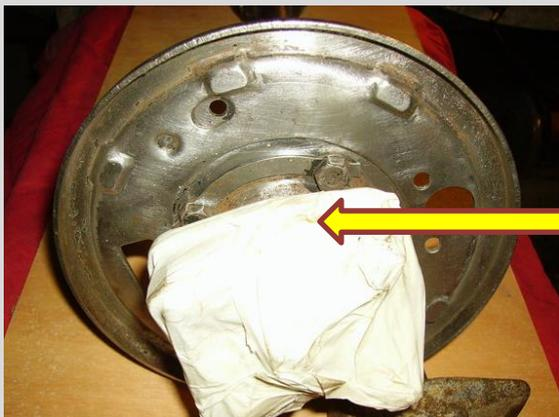
On a bien sur démonté tous le système de freinage, je n'explique pas dans ce tuto puisqu'il existe un tuto sur la réfection des freins. J'ai également contrôlé le roulement et protégé pour la peinture.
