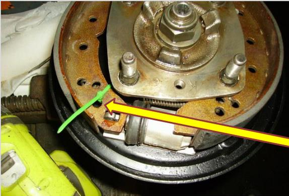
Je ne détaille pas non plus le remontage des freins puisque un tuto est déjà existant. Juste une petite astuce pour éviter de galérer pour remonter les ressort qui tiennent les garnitures, fixé le ressort avec un rilsan puis passé la garniture au-dessus de l'étrier
