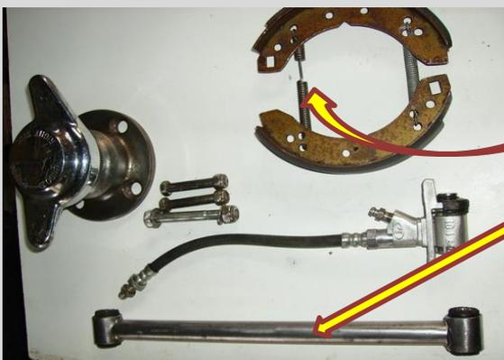
La partie freinage et tirant de roue nettoyer et prêt à peindre que le tirant et les tambours extérieurement.
