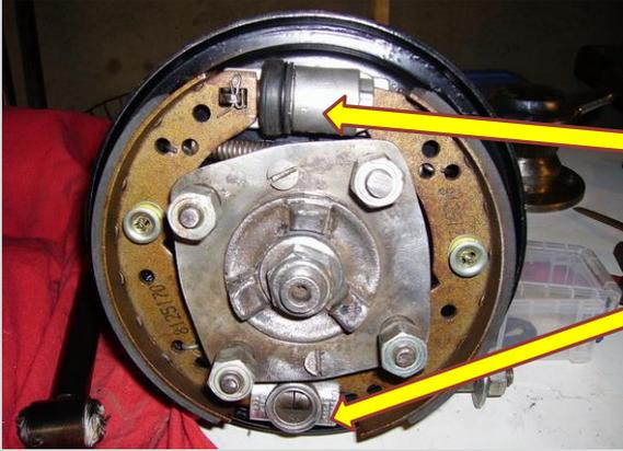
On remonte d'abord l'étrier en le graissant derrière côté cache poussière pour qu'il coulisse correctement. Puis l'excentrique en bas du tambour pour le réglage des garnitures et on rajoute les garnitures.
