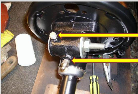
Pour graisser les roulements de roue, il faut **enlever la vis** qui sert de cache et mettre un **graisseur à la place**.
