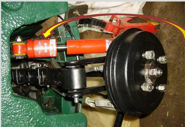
Puis la suspension en haut puis le bras du tirant sur le demi-train d'abord et sur la caisse en suite, remettre le tuyau de frein puis le câble de frein à main et la suspension en bas
