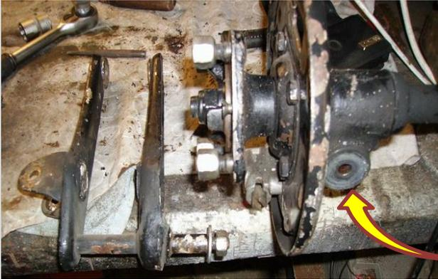
Démontage du bras de suspension et on va vérifier **les tourillons** voir si c'est usée.
