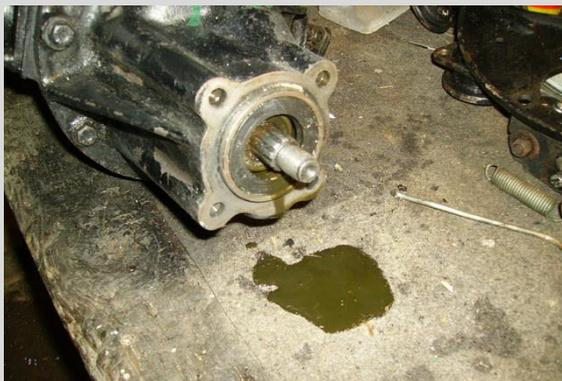
Démontage du boulon du nez de pont qui va permettre de changer le joint spi. Il n'y a pas de vis de vidange, on va donc le vidanger par le nez de pont.
