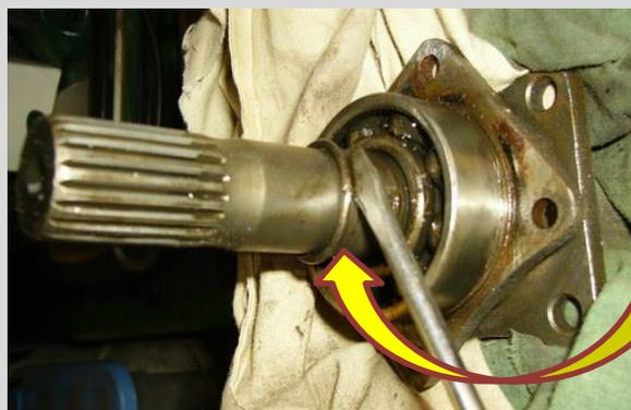
Pour démonter le roulement il faut retirer le clip à l'aide d'un tournevis puis le stocker pour le réutiliser pour la remise du neuf.
