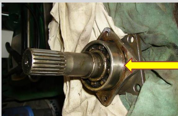
Pour le démontage des demi arbres, pas très compliqué, il suffit de retirer les quatre vis en prenant soin de faire des marques pour le remonter à l'identique. Voilà le résultat ou nous allons pouvoir démonter le roulement.
