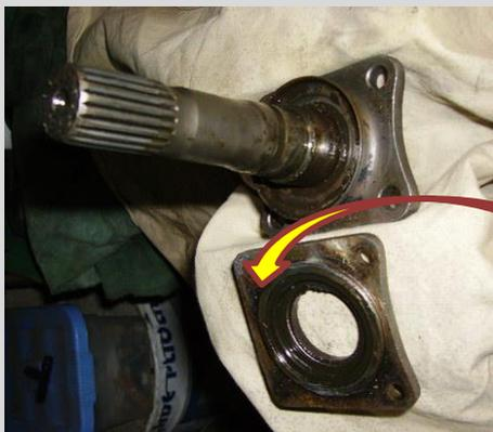
La plaque démontée, nous allons vérifier la tôle ou le joint spi vient se loger
