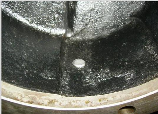
Pour rajouter un bouchon de vidange il faut acheter un bouchon qui va faire l'affaire, pas trop gros qui ne dépasse pas trop. J'ai trouvé un bouchon de diamètre 12 de filetages et une vis six pans pour le desserrer et plat. On trouve ce genre dans tous les magasins d'auto. Il faut percer au bon diamètre et tarauder à 12 pas français.
