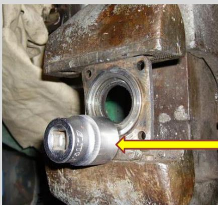
Pour retirer le joint spi, choisir une douille de bon diamètre pour retirer le joint.
