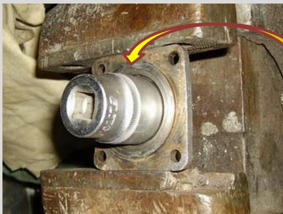
Il suffit de taper avec un maillet en plastique ou un petit marteau et en protégeant la douille à moins que ce soit une vieille douille et dans ce cas, pas besoin de la protéger.
