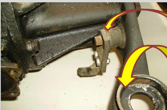
Détail de **la pâte de fixation du pot d'échappement sur la plaque du pont qui supporte les deux sillent bloc.**
