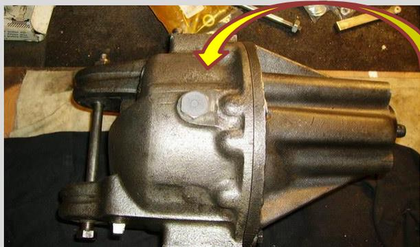
Il ne reste plus qu'à visser le boulon de vidange et de contrôler l'étanchéité à cet endroit. Voilà le pont est révisé, vérifier, il ne reste plus qu'à remonter le tous. Voir tuto suivant pour le remontage.
