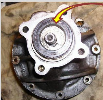
Changement du joint spi du nez pont, le faire tremper dans l'huile de pont toute une nuit avant de le remettre. L'avancer gentiment avec un maillet et une douille du bon diamètre.
