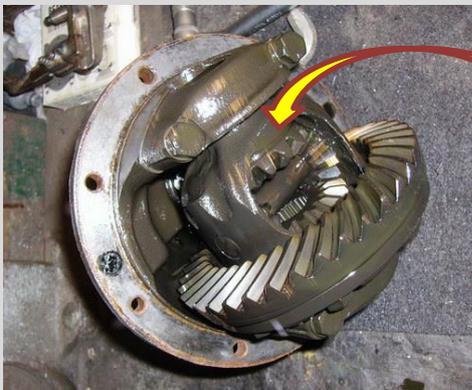
Voilà le résultat, on va pouvoir contrôler les jeux aux pignons d'attaque et ceux des satellites. En ce qui concerne ce pont, pas de jeux inquiétant. le nettoyer mais surtout pas à avec un produit détergeant au risque de lessiver les roulements.
