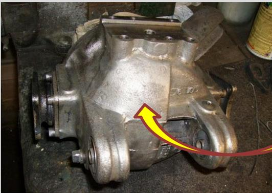
Nettoyage du pont à la brosse métallique sur perceuse avant une ouverture pour contrôle des jeux et changement si nécessaire.
