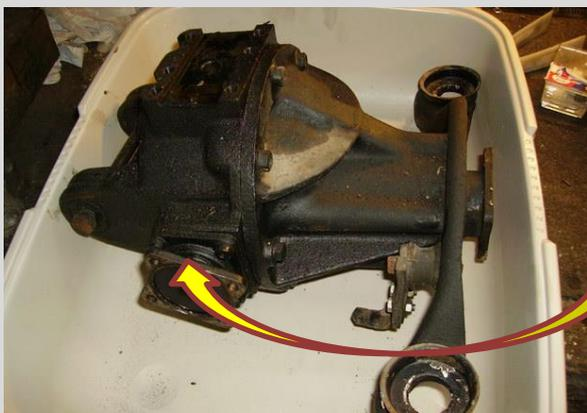
*Le pont est retiré et mis dans un grand bac pour un nettoyage et pour le vidanger.*
