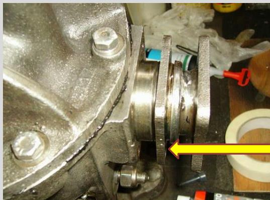
Remettre le roulement en place en s'assurant de bien faire coïncider les marques faites au préalable.
