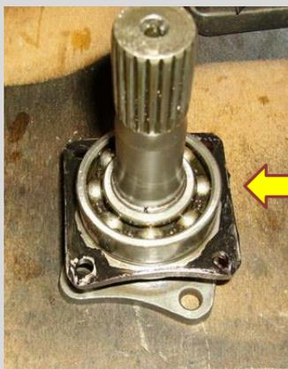
Cela fait, on peut commencer à remonter les deux roulements sur les deux côtés du pont en les induisant d'un joint de bonne qualité, (joint noir aux silicones).
