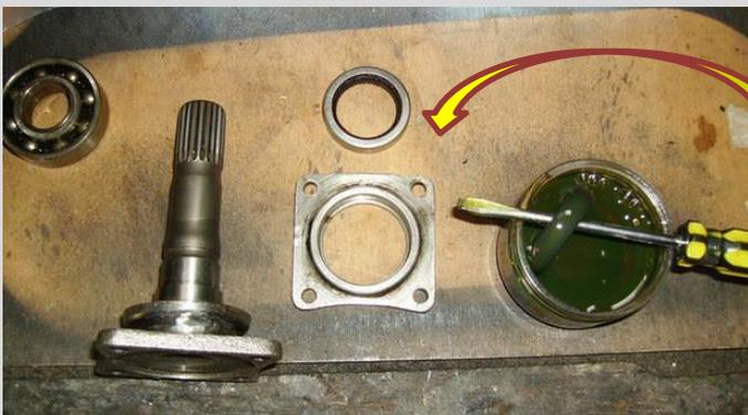
Les joints des roulements avec une différence de qualité. Cage en ferraille sur le vieux et en plastique renforcé pour le neuf.
