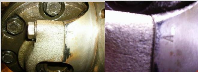
Avant de démonter, il y a une règle à respecter qui est impératif, vérifier le marquage des pièces et s'il n'y a aucune marque ne pas hésiter à en faire. En mécanique, tous doit retourner à la même place.
