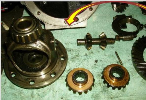
Voilà les satellites sont démontés et dans ce cas je n'ai pas eu besoin de changer les rondelles en cuivre et bombé. Attention à ne pas mélanger les cales de chaque côté des roulements sauf si vous devez diminuer le jeu.
