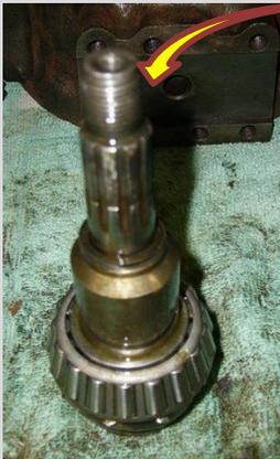
Pour le pignon d'attaque, si le jeu est trop important, il faudra changer les deux roulements opposés mais pour cela il faut un faux pignon et une entretoise neuf pour régler le jeu de calles à mettre sur le nez pont. Si pas de jeu et que vous avez desserré l'écrou pour changement du joints spi, il faut compter le nombre de tour et bien resserrer avec le même nombre de tours que pour les écrous avec goupille
