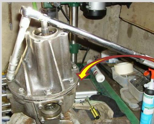
Serrage au couple avec une clef dynamométrique. 2,1 à 2,8
