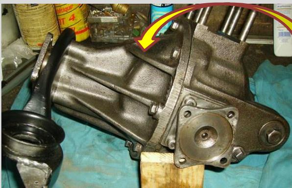
Le bouchon remis on va mettre le pont dans plusieurs positions pour contrôler des éventuelles fuites d'huile, les joints Spi bien monté il ne devrait plus fuir.
