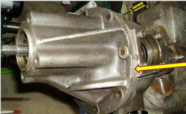
J'avais fait un repère mais normalement on ne peut pas le mettre autrement, il va dans un sens bien précis. Remettre les vis une à une à la main en les rapprochant au plus près.
