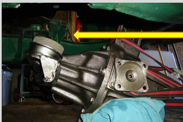
Commencer par positionner les deux attaches devant le pont avec les deux gros Silent bloc. Mettre les deux écrous et faire prendre quelques filets.
