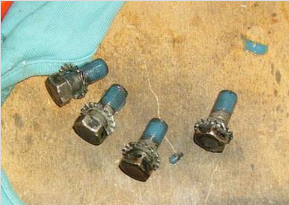
Les quatre boulons enduits de permatex à résistance moyenne bleu pour un démontage éventuel.
