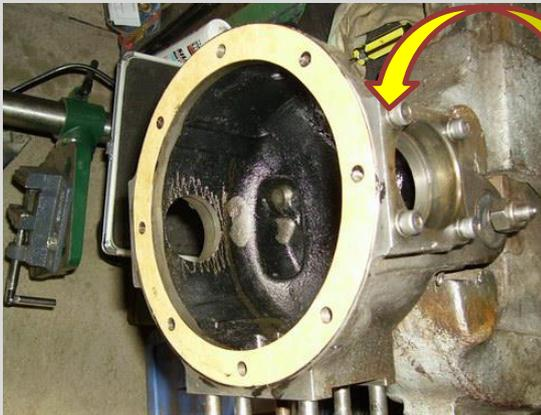
Enduire de joint noir la partie du pont et poser le joint papier sur le pont en appuyant bien sur tous le joint pour répartir le silicone.
