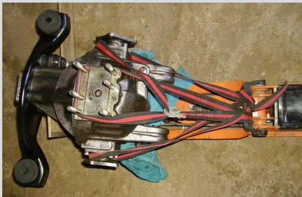
Nous allons pouvoir remonter le pont sur la voiture et tous seul ce n'est pas facile. Mais si, il faut mettre un chiffon dans la camelle pour ne pas abimer la peinture et l'attacher de façon à ne pas gêner le montage avec les sangles.
