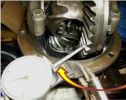
Avant de démonter on peut à l'aide d'un comparateur vérifier le jeu de la couronne est dans ce cas on agit sur les calles des deux roulements en prenant compte le quel côté va être à rapprocher ou à éloigner.
