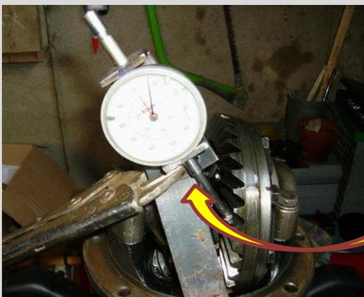
Contrôle de l'usure sur le pignon d'attaque, le jeu ne doit pas dépasser 0.10 à 0.15, en cas de jeux trop important, il faudra changer le pignon d'attaque ainsi que la couronne, on ne peut pas changer l'un sans changer l'autre. Le pont qui se trouve sur ma voiture n'avait pas de jeu et il fallait juste supprimer toutes les fuites à cause des joints spi usés par le temps.
