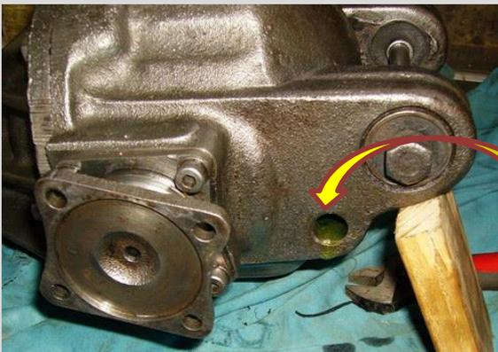
Mettre le pont à peu près de niveau et voir si l'huile coule par le bouchon de remplissage, si oui, serrer le bouchon pas trop fort il est conique.
