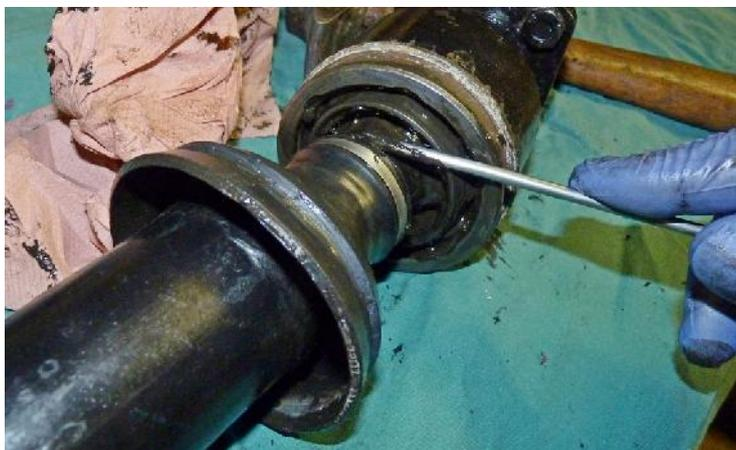
*Au nettoyage on découvre la bague métallique qui maintient le petit bout du soufflet en place.*
