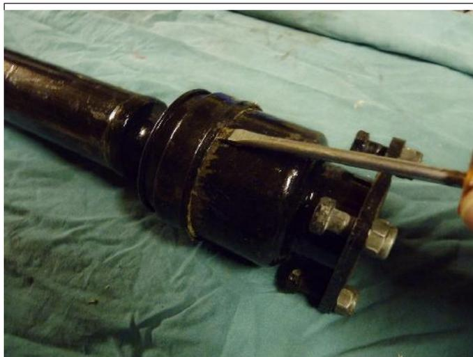
*Insérer un tournevis large sous la bague de maintien du soufflet et faire de petits mouvements de rotation pour dé-sertir légèrement la bague.*
