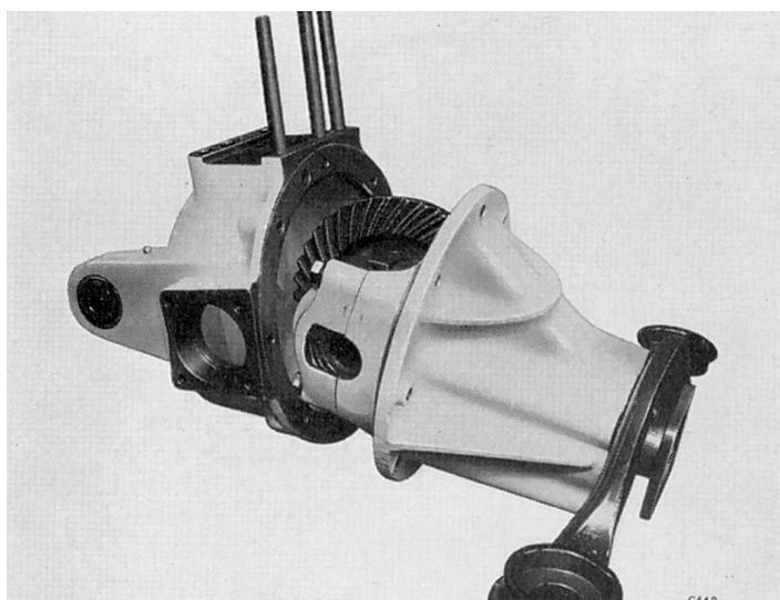
Fig. 30. Dépose du différentiel du carter de pont
