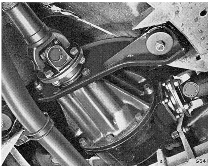
Fig. 26. Vue de dessous du pont hypoïde
