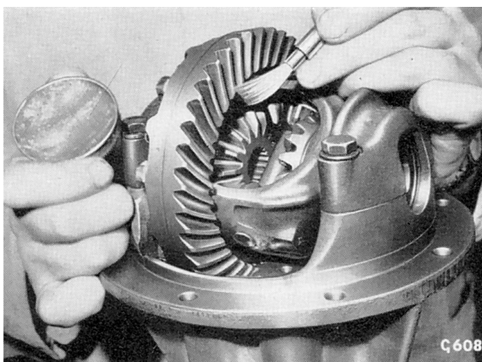
Fig. 55. Application de bleu de marquage sur les dents de la couronne pour vérifier la trace laissée sur le pignon
