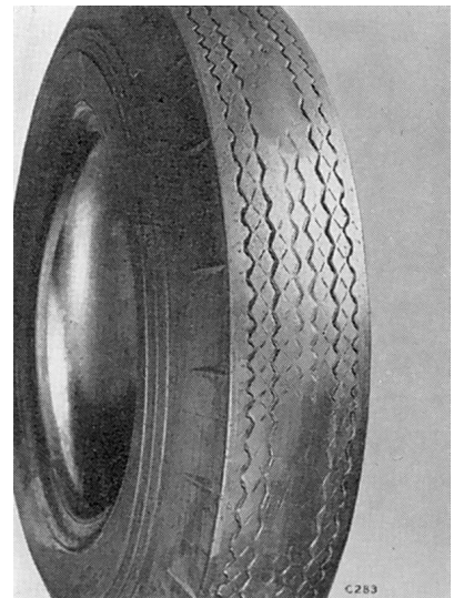
Fig. 11. Usure par endroits de la bande de roulement
