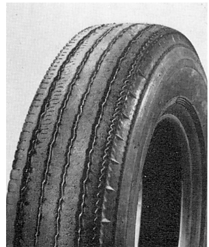
Fig. 12. Usure d'un pneumatique causée par un mauvais parallélisme des roues avant
