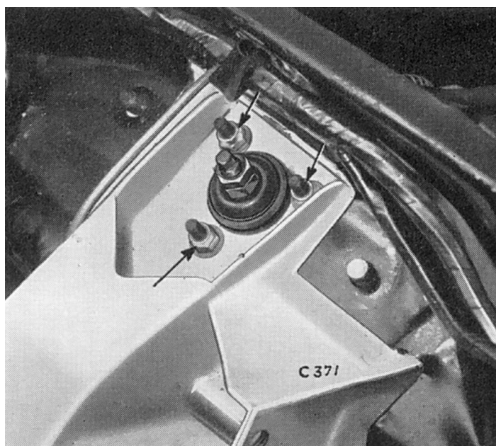
Fig. 26. Fixations du ressort et de l'amortisseur au faux-châssis
