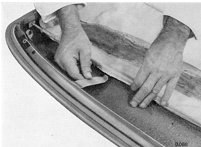
Fig. 44. Assemblage de l'armature au clip de fixation
