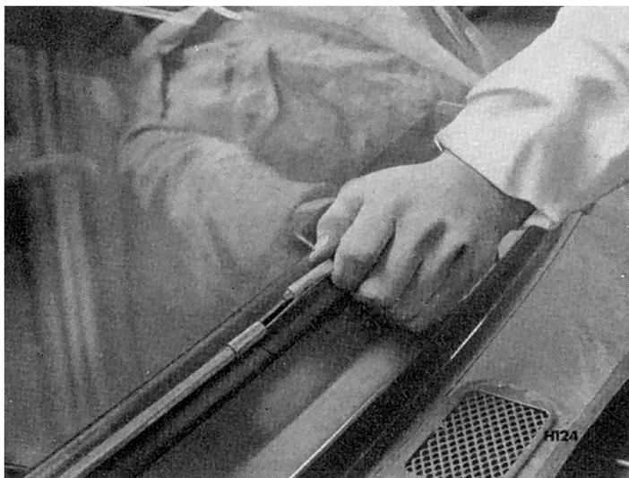
**Fig. 79. Dépose de la moulure de pare-brise****TOUS LES MODÈLES SAUF COUPÉ 1200****Repose du joint sur le pare-brise**
