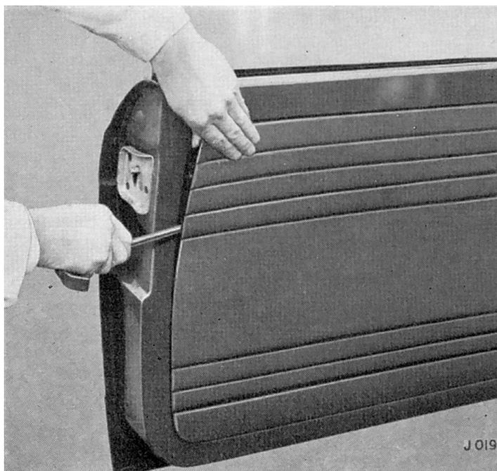
Fig. 66. Démontage du panneau de garniture de portière
