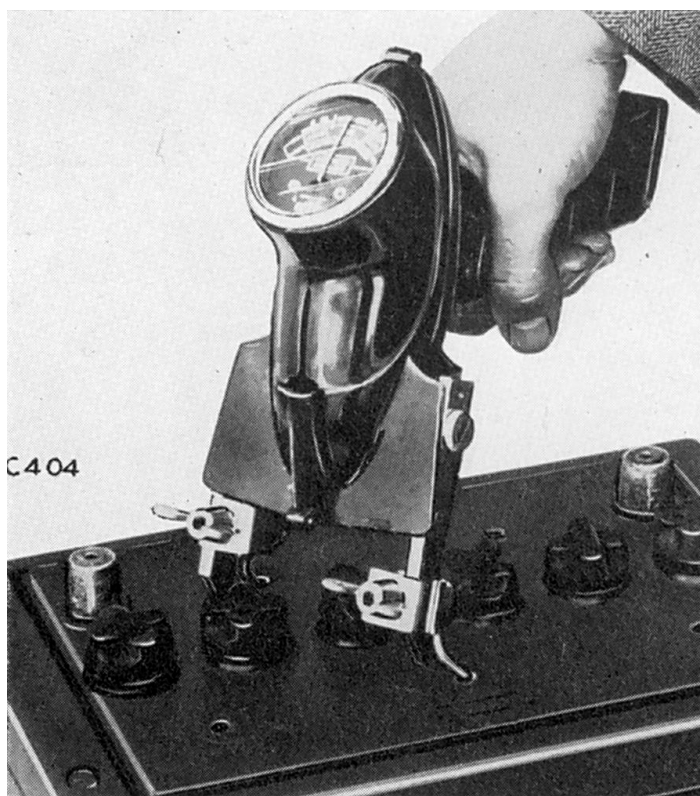
Fig. 6. Utilisation d'un appareil de test de décharge
