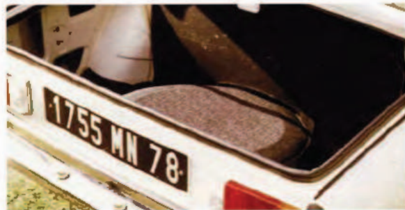
La capacité du coffre reste limitée, et ce d'autant plus qu'il reçoit déjà la roue de secours.
