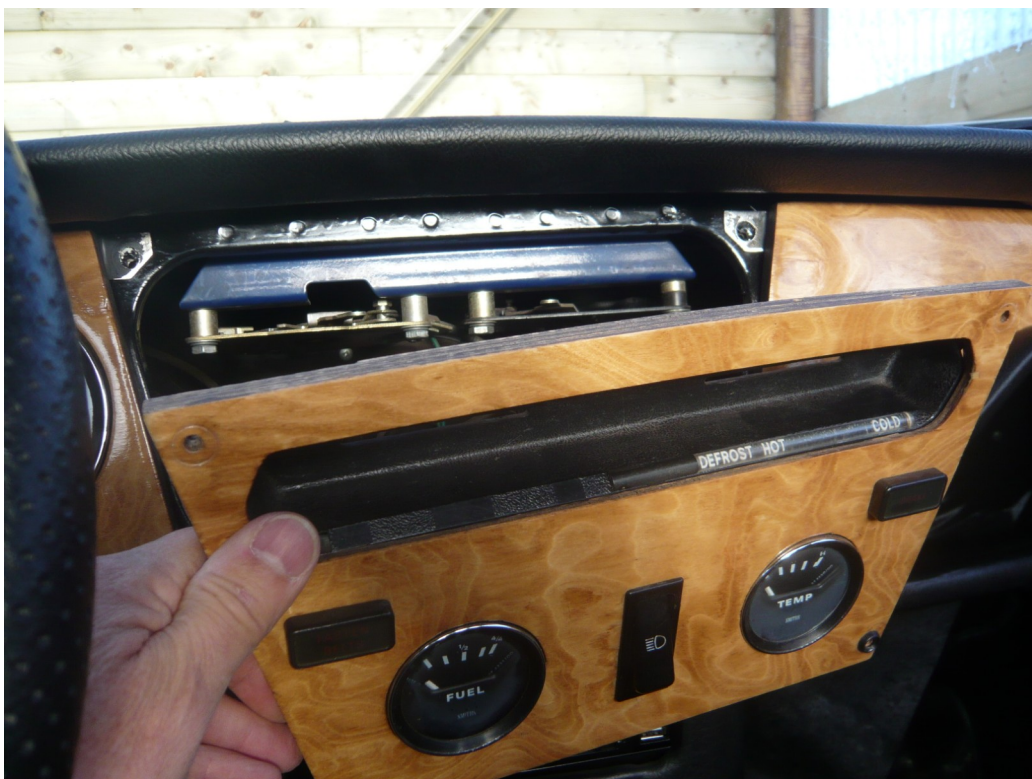
Démontage du panneau central
