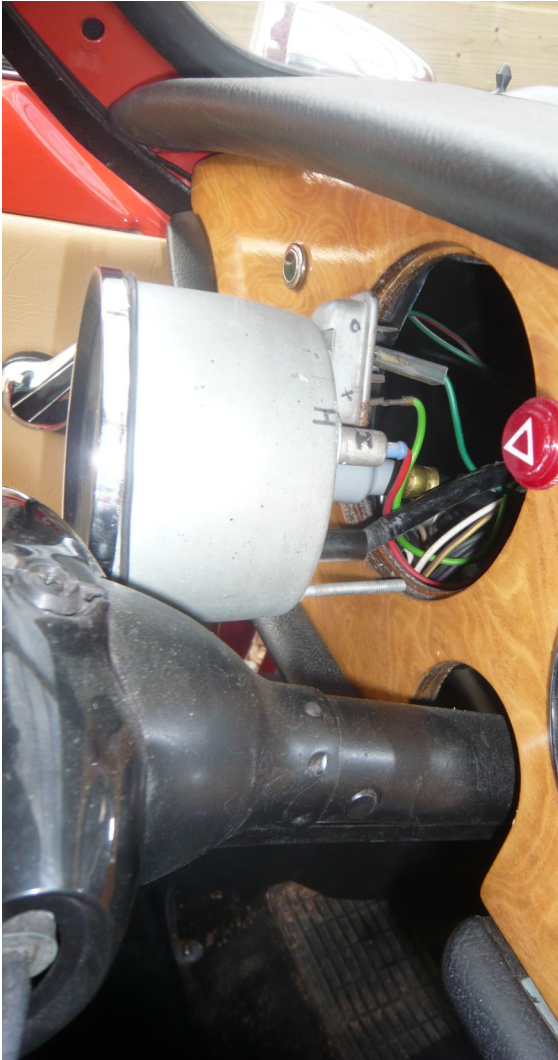
Démontage du compteur de vitesse en passant la main par le trou du compte tour
