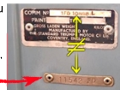
Le "BS. AU48 : 1965", gravé sur cette plaque neuve, est une mention réglementaire anglaise concernant les ceintures de sécurité.
