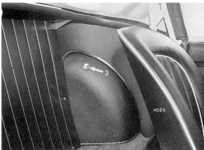
Fig. 79. Fixation de la ceinture de sécurité sur le pasage de roue
