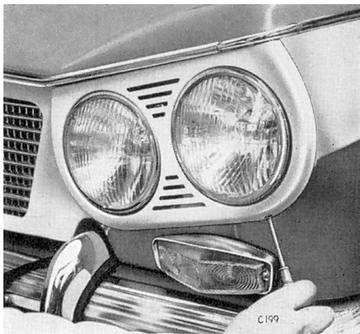
**Fig. 56. Repose de l'encadrement de phare**
